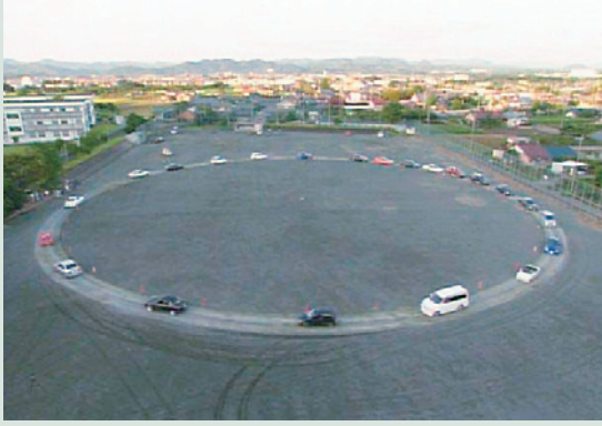
図2 渋滞形成実験。円周230m、22台による円周サーキット上の走行による自然渋滞の発生。 動画は IOP (Institute of Physics) のオンラインジャーナル ( http://www.iop.org/News/news_28849.html ) から、また YouTube ( http://jp.youtube.com/watch?v=7wm-pZp_mi0 ) でも見ることができます。
