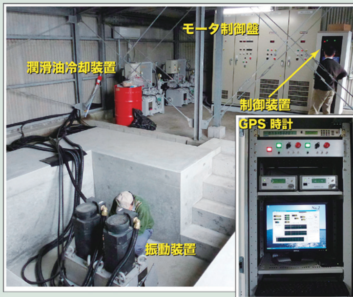
図1 鹿児島大学・京都大学等と協力し、桜島に設置した ACROSS 震源装置。装置はネットワークを利用して名大から遠隔監視・操作されている。
