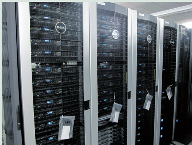
図1 太陽地球環境研究所のスーパーコンピュータ。大型冷蔵庫よりも大きな“箱”の中に市販のパソコンの10倍程度の性能を持つコンピュータが48台収納されている。
